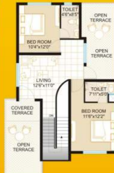
FIRST FLOOR PLAN B. U. A. - 760.00 Sq. Ft. S. B. U. A. - 806.00 Sq. Ft.
